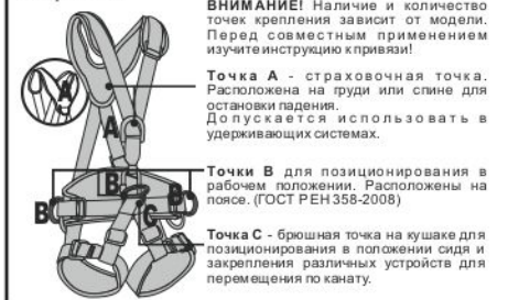
Рис. 3. Расположение и назначение крепежных точек на привязях
