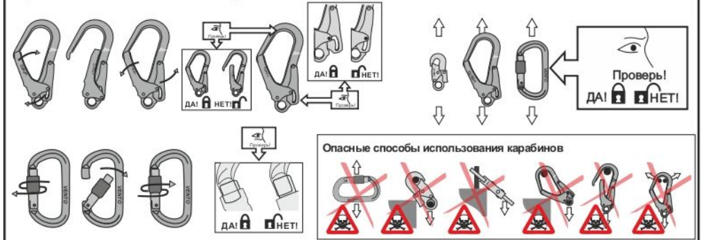
Рис. 6. Способы крепления стропов к анкерным устройствам
