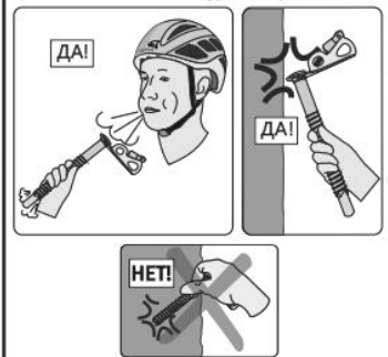
Рис. 10. Очистка ледобура от керна
